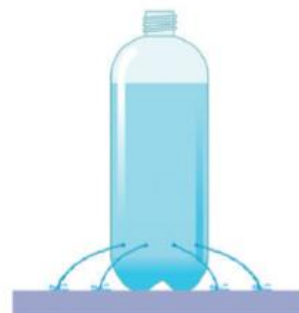
Фиг. 2. Пробийте в пластмасова бутилка няколко еднакви дупки, които лежат в една и съща хоризонтална равнина. Напълнете бутилката с вода. От дупките изтичат еднакви струи вода. Това показва, че във всяка хоризонтална равнина налягането е еднакво.
